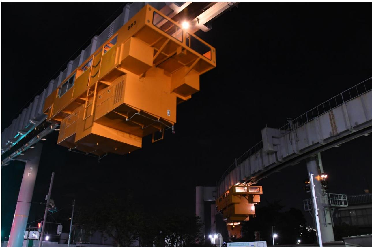
運行終了後、線路、転てつ器、電気設備等の保守、点検を行う点検車。安全運行を確保するために大変重要な役割を担っています。
